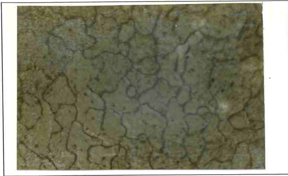
Figura 73 - Micrografia de uma liga solidificada por "melt spinning", mostrando a presença da fase \beta (partículas escuras) (26) .
