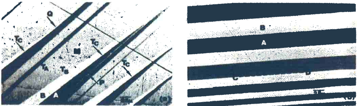
Figura 14 - Micrografia óptica mostrando a morfologia de cunha (a) e com transformação posterior mostrando uma morfologia branco e preto (b). Variantes similares de martensita coalescem, P em (a) e variantes diferentes, A e B interagem formando um plano de junção cujo traço é T_c em (a). A medida que a transformação prossegue, as lanças crescem e se encontram formando uma aparência listrada branca e preta o que remonta a presença de cunhas (b) (5) .
